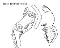
An der Unterseite des Scheinwerfers ① kann ein weißer Rückstrahler ② montiert werden. Der Rückstrahler ist mit zwei Stiften versehen, die in die entsprechenden Öffnungen in dem Scheinwerfer passen. Zur dauerhaften Befestigung wird der Rückstrahler an den Scheinwerfer angeschraubt.
