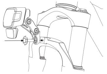
Scheinwerfer 1 mittels Stahlhalterung am Fahrrad befestigen und darauf achten, dass sich der Scheinwerfer (1) nicht von allein wieder verstellen kann (Schraube fest genug anziehen!).
