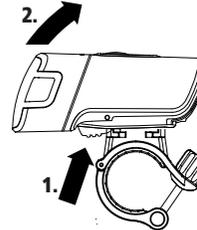
1. Lösetaste auf Unterseite betätigen und Frontscheinwerfer abheben (2.)
