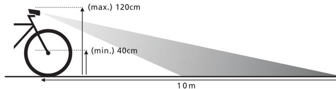
Richten Sie den Scheinwerfer so aus, dass der Lichtkegel bis ca. 10 Meter vor dem Rad auf die Fahrbahn reicht (siehe Abbildung). Der Scheinwerfer muss in einem Bereich von 400 bis 1200 mm über der Fahrbahn montiert werden.
