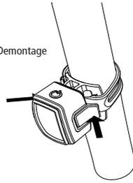
Lösehebel beidseitig (gleichzeitig) betätigen und das Rücklicht abziehen.
